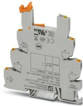
Borne de base PLC de 6,2 mm para funciones de salida con conexión push-in, sin equipamiento de relé o relé de estado sólido, para montar sobre carril NS 35/7,5, con conexión de línea de retorno de carga (BB), 1 contacto de cierre, tensión de entrada 24 V AC/DC
