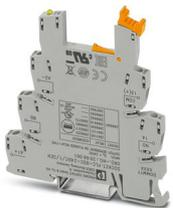
Borne de base PLC de 6,2 mm para funciones de entrada con conexión por tornillo, sin equipamiento de relé o relé de estado sólido, para montar sobre carril NS 35/7,5, con distribución de tensión de alimentación de sensor (BB), 1 contacto de cierre, tensión de entrada 24 V DC
