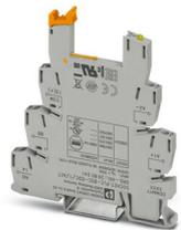
Borne de base PLC de 6,2 mm para funciones de salida con conexión por tornillo, sin equipamiento de relé o relé de estado sólido, para montar sobre carril NS 35/7,5, con conexión de línea de retorno de carga (BB), 1 contacto de cierre, tensión de entrada 24 V DC
