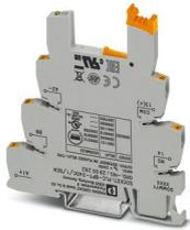
Borne de base PLC de 6,2 mm para funciones de entrada con conexión push-in, sin equipamiento de relé o relé de estado sólido, para montar sobre carril NS 35/7,5, con distribución de tensión de alimentación de sensor (BB), 1 contacto de cierre, tensión de entrada 24 V DC
