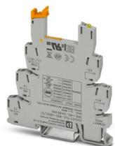
Borne de base PLC de 6,2 mm con conexión por tornillo, sin equipamiento de relé o relé de estado sólido, para montar sobre carril NS 35/7,5, 1 contacto conmutado, tensión de entrada 48 V DC
