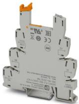
Borne de base PLC de 6,2 mm para funciones de salida con conexión por tornillo, sin equipamiento de relé o relé de estado sólido, para montar sobre carril NS 35/7,5, con conexión de línea de retorno de carga (BB), 1 contacto de cierre, tensión de entrada 24 V AC/DC
