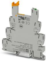
Borne de base PLC de 6,2 mm contra corrientes parásitas y/o tensiones parásitas en el lado de control con conexión por tornillo, sin equipamiento de relé o relé de estado sólido, para montar sobre carril NS 35/7,5, con absorción de corriente de entrada ampliada, 1 contacto conmutado, tensión de entrada 24 V DC
