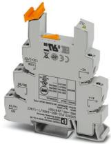
Borne de base PLC de 14 mm para funciones de salida con conexión por tornillo, sin equipamiento de relé o relé de estado sólido, para montar sobre carril NS 35/7,5, con conexión de línea de retorno de carga (BB), 2 contactos de cierre (1-1), tensión de entrada 24 V DC
