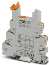
Borne de base PLC de 14 mm con conexión push-in, sin equipamiento de relé o relé de estado sólido, para montar sobre carril NS 35/7,5, 2 contactos conmutados, tensión de entrada 48 V DC
