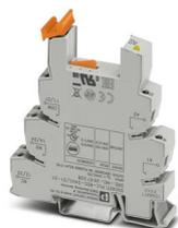
Borne de base PLC de 14 mm con conexión por tornillo, sin equipamiento de relé o relé de estado sólido, para montar sobre carril NS 35/7,5, 2 contactos conmutados, tensión de entrada 24 V AC/DC
