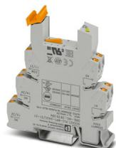
Borne de base PLC de 14 mm con conexión push-in, sin equipamiento de relé o relé de estado sólido, para montar sobre carril NS 35/7,5, 2 contactos conmutados, tensión de entrada 24 V AC/DC
