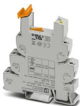
Borne de base PLC de 14 mm con conexión por tornillo, sin equipamiento de relé o relé de estado sólido, para montar sobre carril NS 35/7,5, 2 contactos conmutados, tensión de entrada 48 V DC
