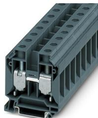
Borne de paso, tensión nominal: 1000 V, corriente nominal: 125 A, tipo de conexión: Conexión por tornillo, Sección de dimensionamiento: 35 mm<sup>2</sup>, sección: 10 mm<sup>2</sup> - 35 mm<sup>2</sup>, clase de montaje: NS 35/7,5, NS 35/15, color: gris oscuro
