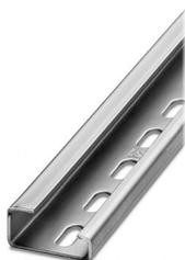
Carril simétrico perforado, según EN 60715, material: Acero, galvanizado, pasivado de capa gruesa, Perfil G, color: plata, Variante de embalaje con 10 unidades (20 m)
