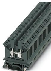
Borne de paso, tensión nominal: 800 V, corriente nominal: 32 A, tipo de conexión: Conexión por tornillo, Sección de dimensionamiento: 4 mm<sup>2</sup>, sección: 0,5 mm<sup>2</sup> - 6 mm<sup>2</sup>, clase de montaje: NS 35/7,5, NS 35/15, NS 32, color: gris oscuro
