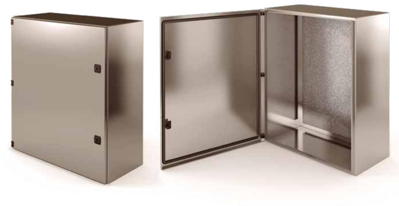
Se fabrican en acero inoxidable AISI 304. Con el fin de garantizar un elevado índice de estanqueidad se le aplica a la puerta un burllete de poliuretano de manera continua que incide sobre un laberinto rematado en labio bota agua de nuevo diseño.
